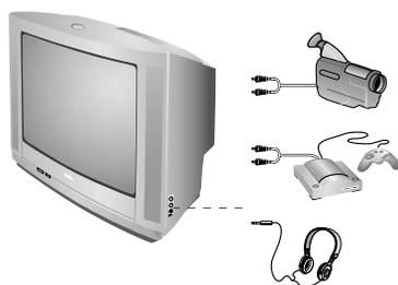
Afhankelijk van de uitvoering zitten de aansluitingen op de voorkant (soms onder een klepje) of op de rechterkant van het televisietoestel. Maak de aansluitingen zoals hiernaast is weergegeven. Met de toets **AV**, kies AV.
