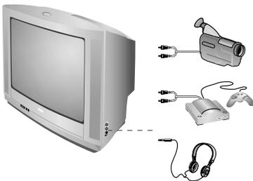
Je nach Modell befinden sich die Anschlüsse auf der Vorderseite (manchmal hinter einer Klappe) oder auf der rechten Seite des Fernsehgeräts.
