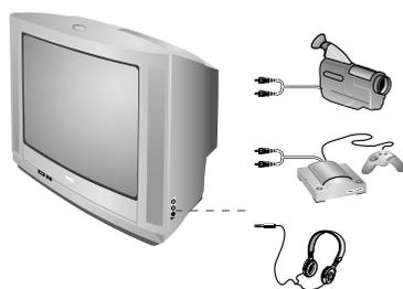
A seconda delle versioni, le prese sono situate anteriormente (talvolta sotto uno sportellino) o sul lato destro del televisore. Eseguire i collegamenti di cui a lato.
