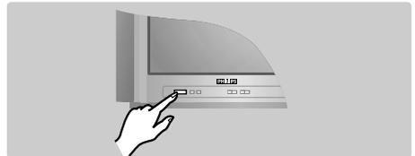
λειτουργίας/διακοπής (ON/OFF). Τότε ανάβει μια κόκκινη λυχνία και φωτίζεται η οθόνη. Διαβάστε αμέσως το κεφάλαιο Γρήγορη εγκατάσταση στην επόμενη σελίδα. Αν η τηλεόραση βρίσκεται σε κατάσταση αναμονής, πιέστε το πλήκτρο P (+) του τηλεχειριστηρίου. Η λυχνία αναβοσβήνει όταν χρησιμοποιείτε το τηλεχειριστήριο.
