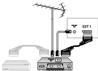
Eseguire i collegamenti necessari. Utilizzare un cordone di collegamento (presa scart) di tipo europeo di buona qualità.
